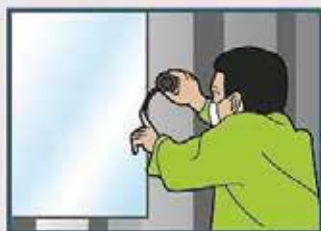
ใช้ปืนยิงตะปู-ตะนากาว ติดแผ่นฟอยล์ที่ยื่นออกมา ด้านข้างของ Roof Batt เพื่อยึด Roof Batt ให้อยู่ที่โครง
