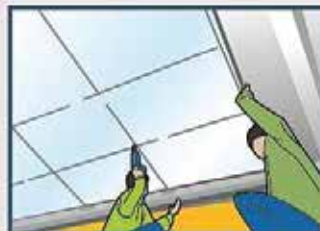
Roof Batt ที่ยึดติดกับจันทันแล้วจะเรียงเป็น แถวเดียวกัน
