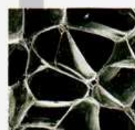
ฉนวนแอโรฟลักซ์ (Aeroflex) ฉนวนชนิดเซลล์ปิด (Closed Cell Structure) ภาพจากกล้องจุลทรรศน์อิเล็กโตรนิกขยาย 50 เท่า จะสามารถเห็นโครงสร้างเซลล์ปิดซึ่งมีลักษณะผนังเซลล์กั้นกันไม่ทะลุถึงกัน
