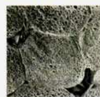
ฉนวนโฟม (Polystyrene Foam) ชนิดเซลล์ยึด (Interconnecting Cell) ภาพถ่ายจากกล้องจุลทรรศน์อิเล็กโตรนิกขยาย 5 เท่า จะสามารถเห็นภาพโครงสร้างเม็ดโฟมพลาสติกสีดำนซึ่งเป็นเม็ดเล็กๆ มาติดต่อกันซึ่งทำให้มีรูอากาศที่น้ำและความชื้นสามารถแทรกซึมผ่านเข้าไปได้ง่าย โดยเฉพาะโฟมชนิดความหนาแน่นต่ำ
